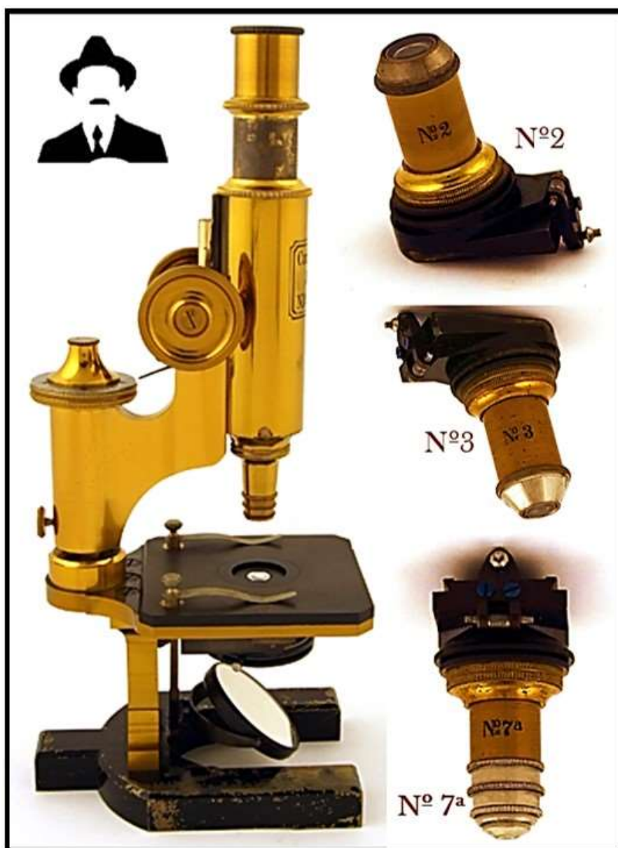
Figura 5. Microscopio Carl Zeiss, Jena, VI a. Con sus objetivos números 2, 3 y 7a (el tamaño de las imágenes no es proporcional).
