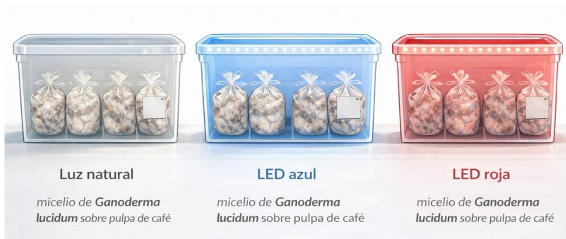
Figura 1. Cámaras de crecimiento con medidas de 27 cm de ancho × 53 cm de largo × 30 cm de alto acondicionadas con diferentes espectros de luz visible, donde se dispusieron 8 bolsas de 500 gr de pulpa de café e inoculadas con micelio de Ganoderma lucidum
